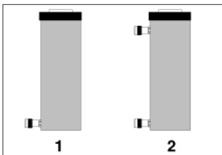
一个带有 4 通阀的泵和 2 根液压软管连接 (如图 2 所示)。
