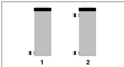
**BELANGRIJK:** Bij dubbelwerkende cilinders moeten beide koppelingen aangesloten zijn.
