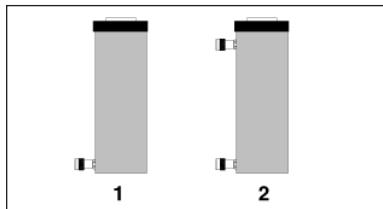
2. 下に示すようにシリンダのエア抜きを行います。
